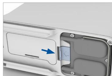
11. Wechselstromkabel am Inogen One® G4 und Netzkabel an einer Steckdose anschließen. Den Inogen One® G4 Konzentrator nicht einschalten.
