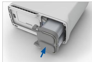
10. Die Säuleneinheit so in das Gerät schieben, dass sie sich vollständig im Inogen One® G4 Konzentrator befindet. Die gefederte Arretiertaste sollte wieder vollständig in die geschlossene Position zurückkehren.
